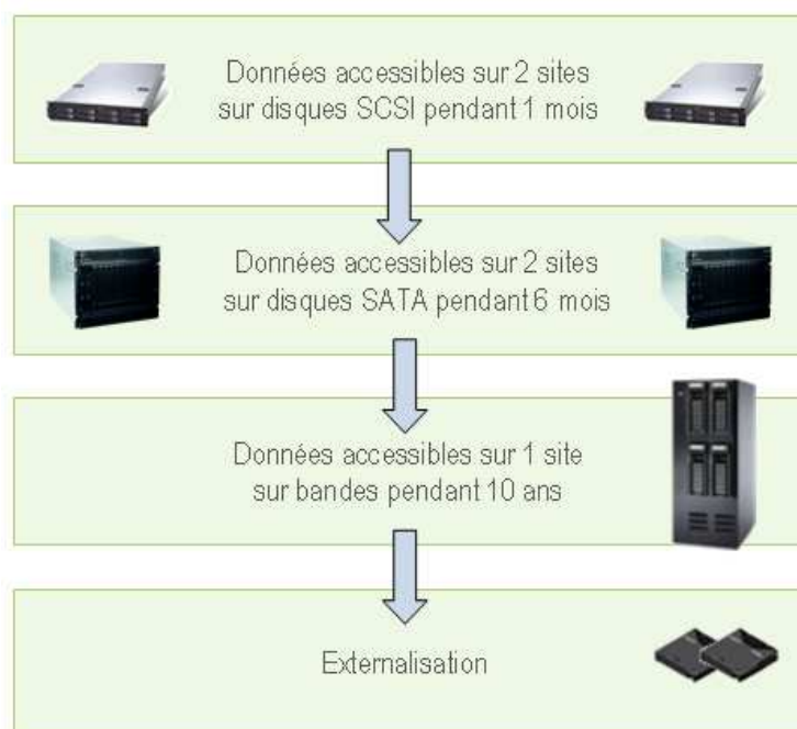
Fig 6 – exemple de paramétrage du stockage hiérarchique
